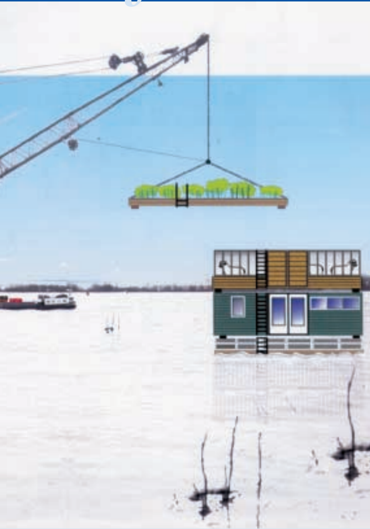
Een inzending van Martijn Schoots voor de prijsvraag 'Amfibisch wonen'. In de zomer staan schuur, zomer, schapenverblijf en volkstuintje in de uiterwaarden, in de winter worden ze gestapeld. De basis is een container die 's zomers dienst doet als tuin en terras.
