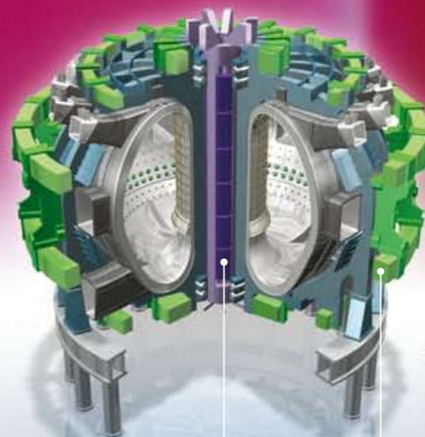
Zes centrale transformatorspoelen
