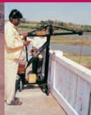
Een Indiase werknemer van het Hydrology Project meet de snelheid van rivierwater.
