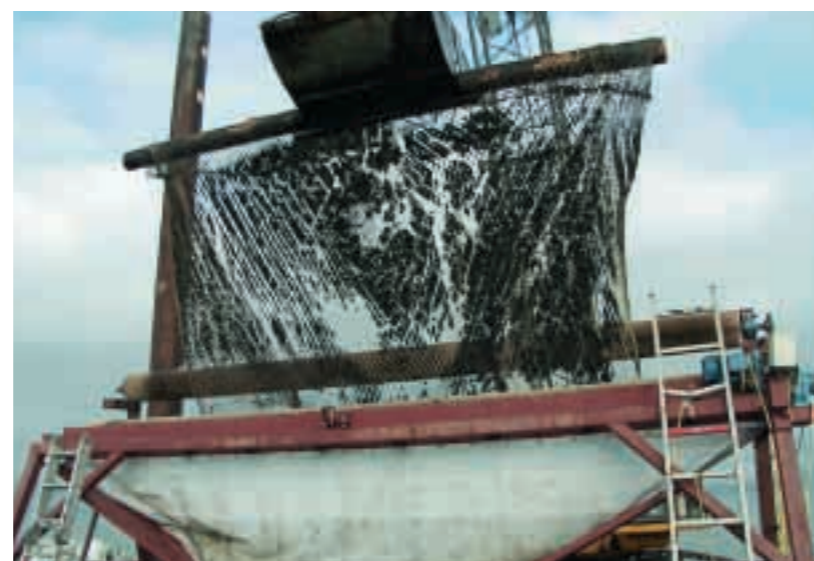
Mosselzaad hangt boven de borstelmachine van machinefabriek Bakker. De opbrengst is niet gelijkmatig verdeeld, omdat het net niet altijd strak heeft gehangen.
