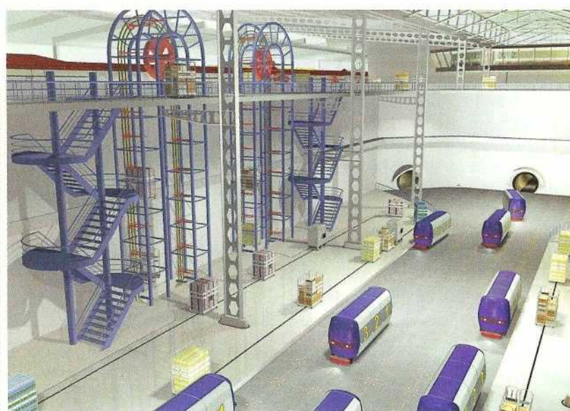
De containers verdwijnen met liften in het LSP onder de grond.
