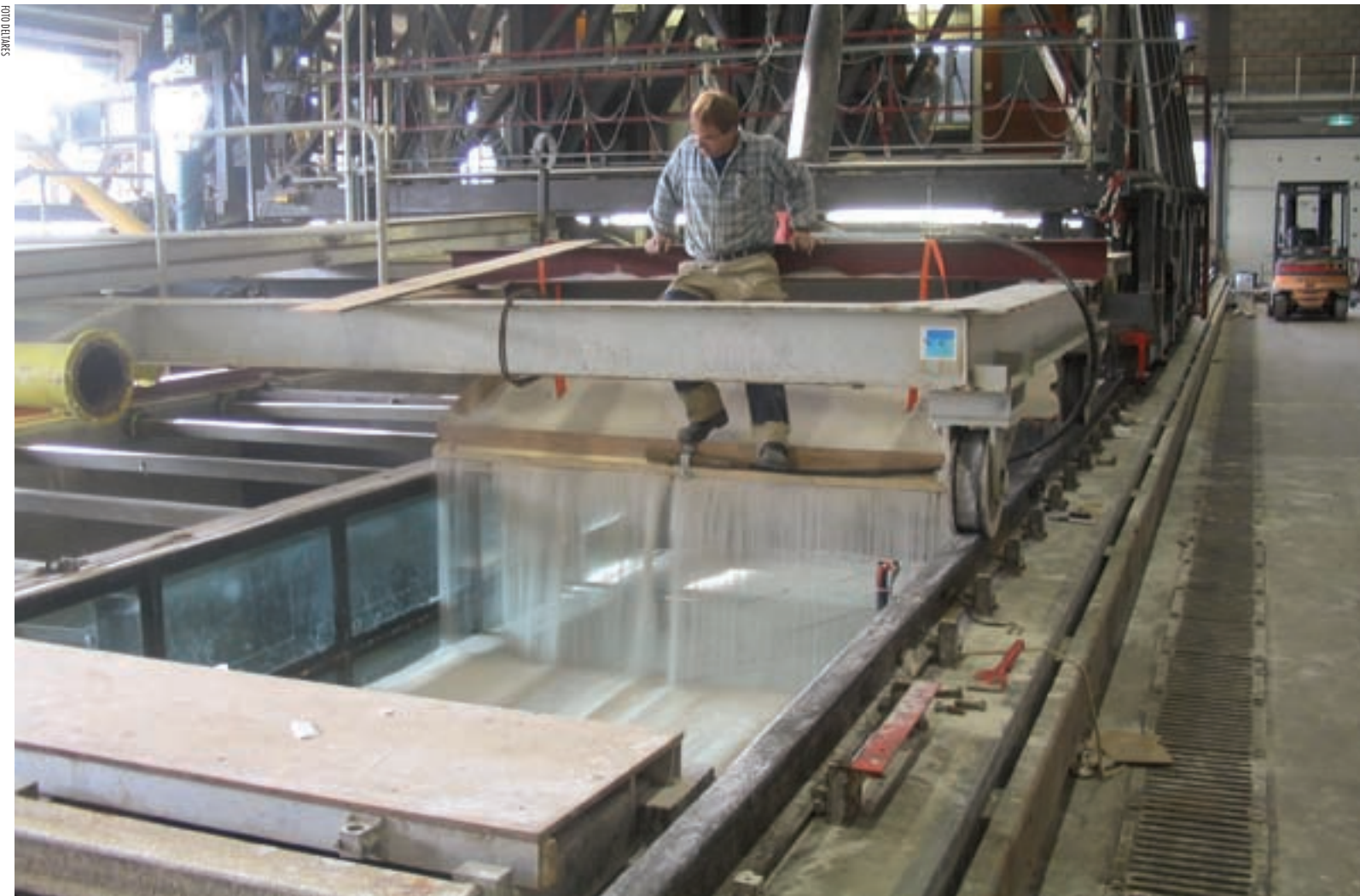
Voor de proef wordt in een van de goten bij Deltares een deklaag van zand aangebracht op een laag slappe klei.
