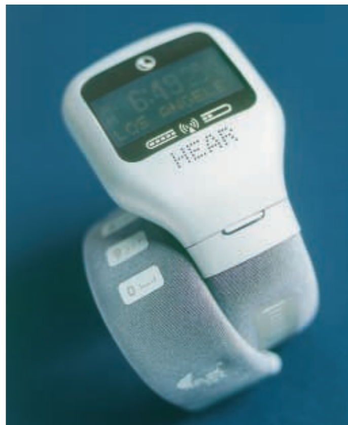
Het mobieltje als armband is een product van ElectroTextiles. Telefoonmodule en band zijn uit elkaar te halen. De module past op andere producten van ElectroTextiles.
