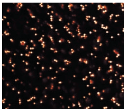
Opnamen met een confocale microscoop van een mengsel van colloïden en polymeren. De colloïdale deeltjes klonteren op den duur samen als gevolg van het toegevoegde polymeer. Er ontstaat een wanordelijk sediment. De volumfractie aan colloïdale deeltjes was 2,24 % en de concentratie polymeer 8,07 mg/ml. Het plaatje links is opgenomen na 39 seconden, Het plaatje rechts na 8:54 minuten.
