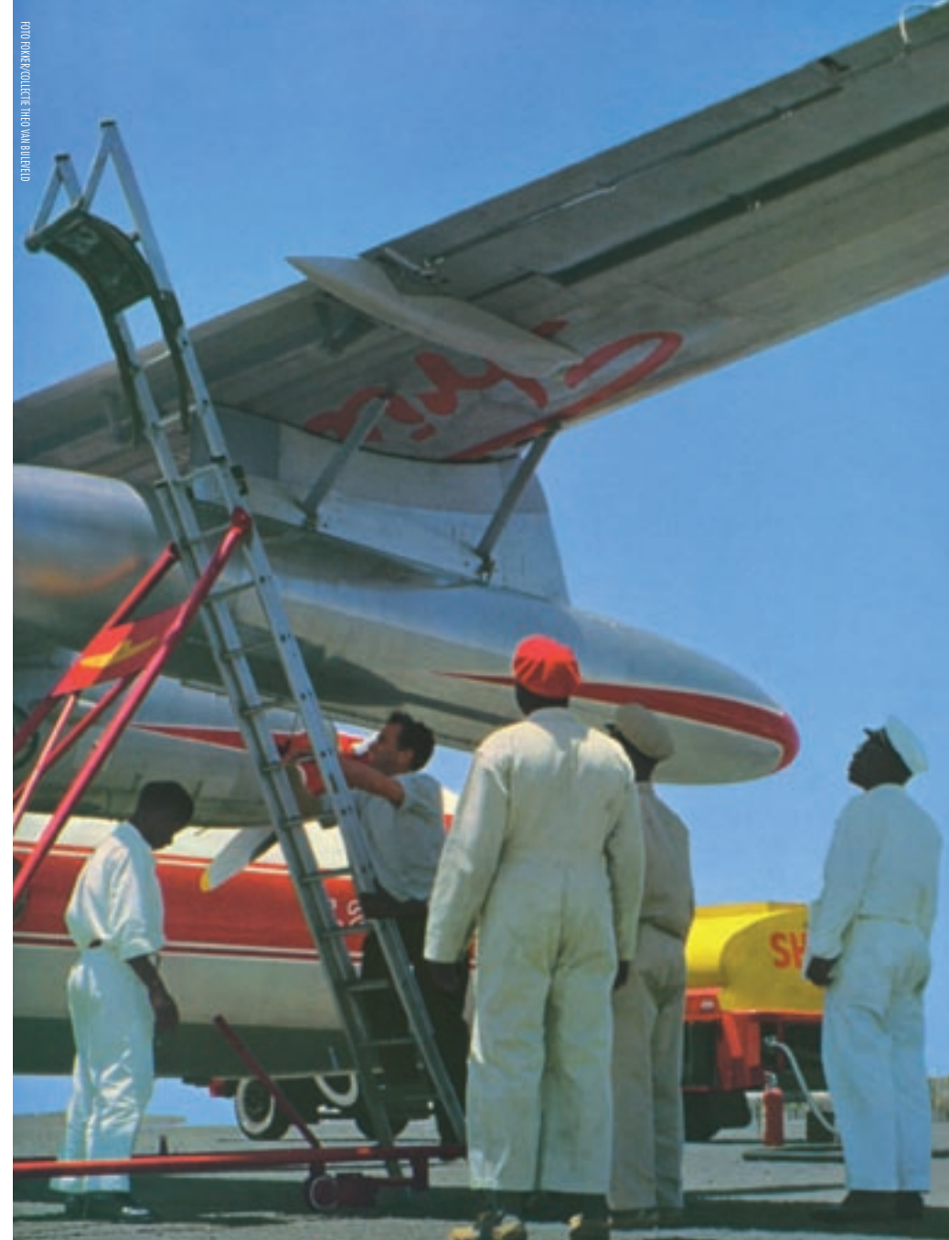
Promotietoer met het prototype van de Friendship. Om lange afstanden te kunnen vliegen is dit toestel voorzien van extra brandstoftanks onder de vleugel.
