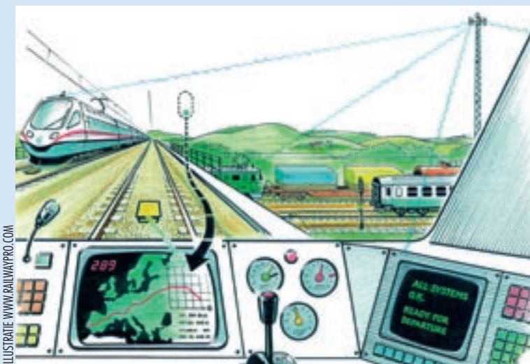
Met het beveiligingssysteem ERTMS/ETCS staan treinen draadloos met elkaar in verbinding en weten zij elkaars posities. De machinist ziet de seinen op een beeldscherm in de cabine, evenals het traject met alle benodigde informatie.
